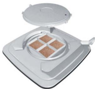
über die Biotonne als Bioabfall. Der neue Filter muss bei Inbetriebnahme angefeuchtet werden, um die Mikroorganismen zu aktivieren, und die Filterkammern durch Aufquellen vollständig auszufüllen. Nach Zugabe von ca. 500 ml Wasser quellen die Presslinge von alleine innerhalb von 15-30 Sek. vollständig auf.
